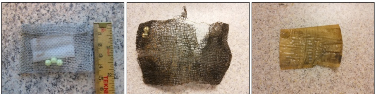
Figur 3.4. Till vänster: Påse med Ascaris suum ägg i skyddande näthölje innan tillsättning till reaktorn. Mitten: Näthölje som vandrat genom reaktorn. Till höger: påse innehållandes Ascaris suum ägg som vandrat genom reaktorn i näthölje.
