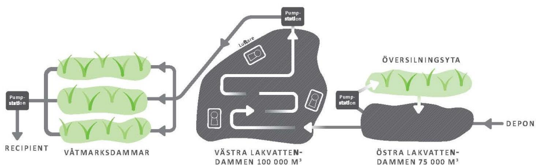
Figur 1.3 Lakvattenreningsystemet vid Gärstad avfallsanläggning.
