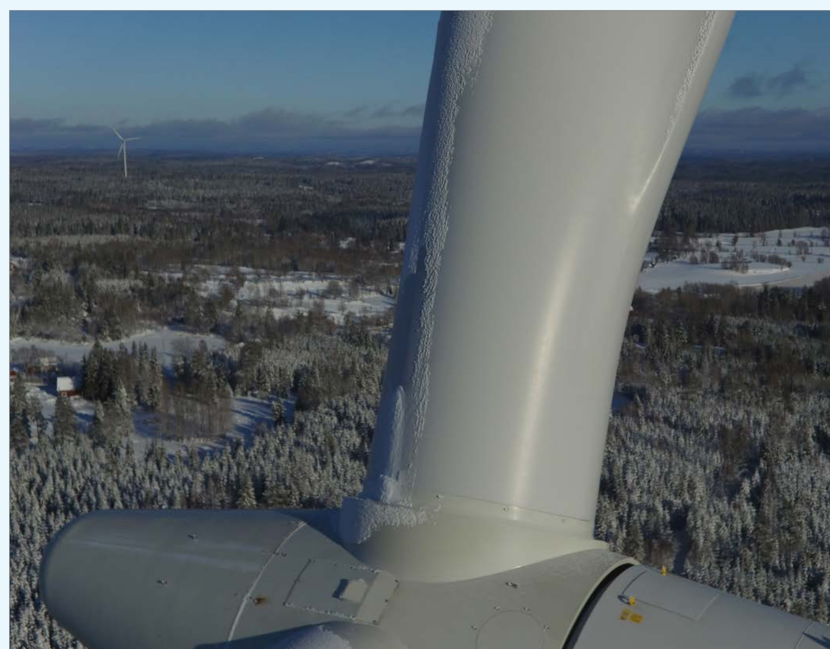
Isbildning på vindkraftverk
